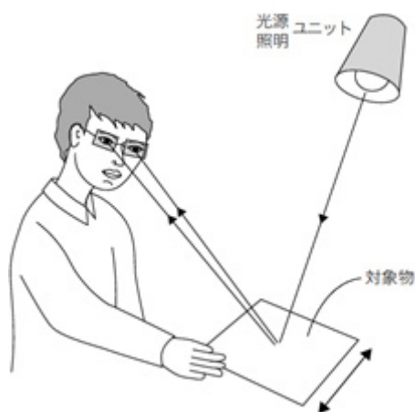
図 12 対象物を振ると欠陥が見えてくる
